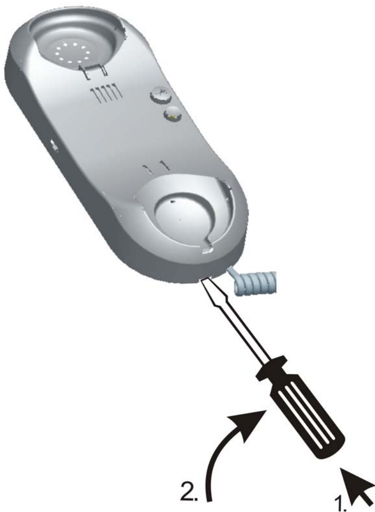
obr.2 Postup pri demontáži krytu DT Postup při demontáži krytu DT
